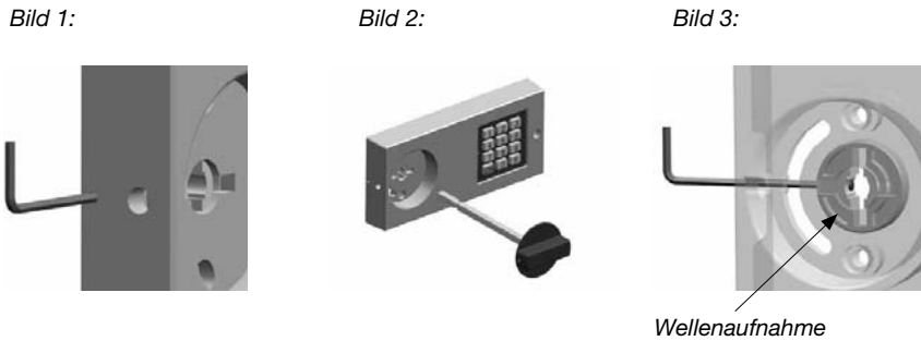
Abb. 5: Balkengriffdemontage, waagerechter Aufbau
